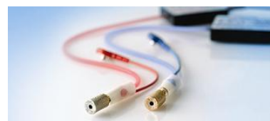
Met goudfolie bedekte oorplug die aan de kabel is verbonden
